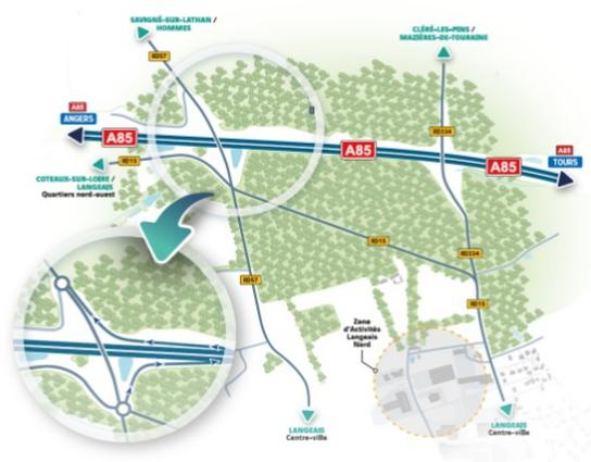
Ce nouveau demi-diffuseur sera composé, pour les usagers de l'autoroute A85 en provenance et à destination de Tours, d'une bretelle d'entrée et d'une bretelle de sortie au niveau de la RD57.
